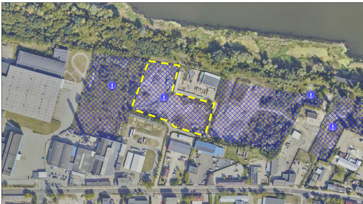
Rysunek 7. Położenie obszaru objętego opracowaniem (żółta linia przerywana) na tle obszaru historycznego zanieczyszczenia powierzchni ziemi (niebieski szraf z symbolami „!”) – dane Głównego Inspektoratu Ochrony Środowiska (źródło: Geoserwis GDOŚ)
